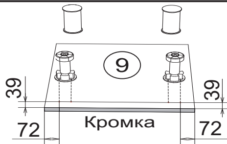
Схема установки межсекционной стяжки
