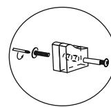
После установки всей конструкции рекомендуется стянуть между собой все секции межсекционной стяжкой, предварительно выровнив их между собой. Отверстия делаются по месту диаметром 5-6 мм. Советуем сделать их чуть глубже петель.
